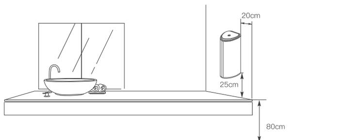
NOTA: se la superficie sottostante è in acciaio, la distanza dal sensore dev'essere di almeno 35 cm.
